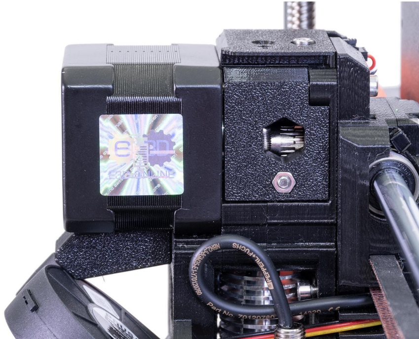
Рисунок 40 – Прочищення екструдерного ролика через бокове вікно
