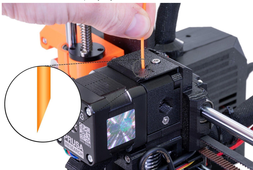
Рисунок 9 – Завантаження філаменту до екструдера
