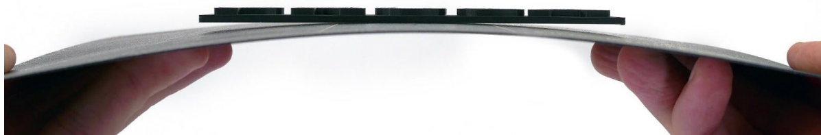
Рисунок 13 – Звільнення PEI-листа від надрукованого об'єкта шляхом вигинання
