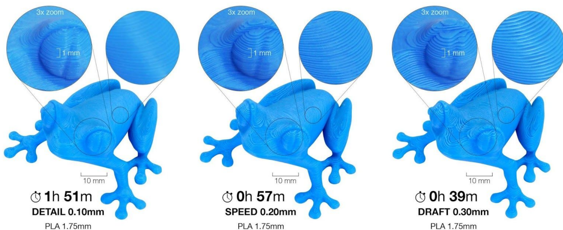
Рисунок 19 – Якість друку порівняно з його швидкістю: три профілі налаштування висоти шарових наплавлень при роботі з філаментною ниткою PLA товщиною 1,75 мм (зображення фрагментів об'єкта збільшено втричі)
