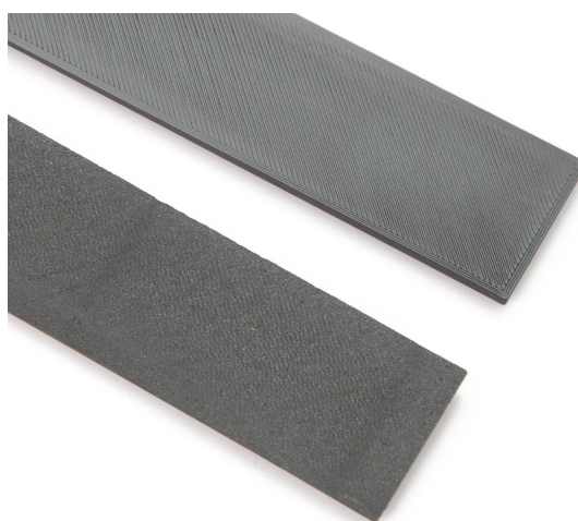
Рисунок 7 – Вигляд сталевого PEI-листа з гладким (зверху) та порошковим (знизу) покриттям
