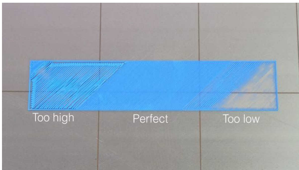
Рисунок 11 – Коректно налаштований друк першого філаментного шару (зліва направо: занадто високе, задовільне, занадто низьке положення сопла над столом)
