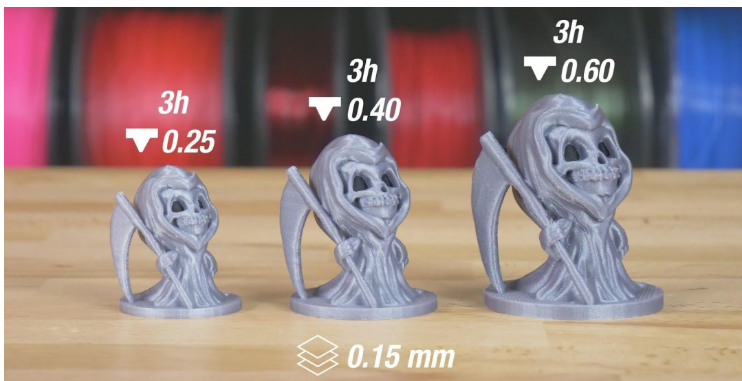
Рисунок 22 – Порівняння діаметра сопла зі швидкістю друку Лівий об'єкт: діаметр сопла 0,25 мм, тривалість друку 3 год Центральний об'єкт: діаметр сопла 0,40 мм, тривалість друку 3 год, висота шарових наплавлень 0,15 мм Правий об'єкт: діаметр сопла 0,60 мм, тривалість друку 3 год
